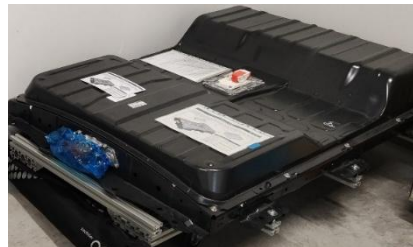
banc batterie de 40 kWh
