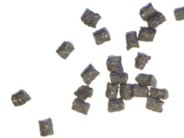
Feedstock granulés de polymère chargés de poudre de NdFeB
